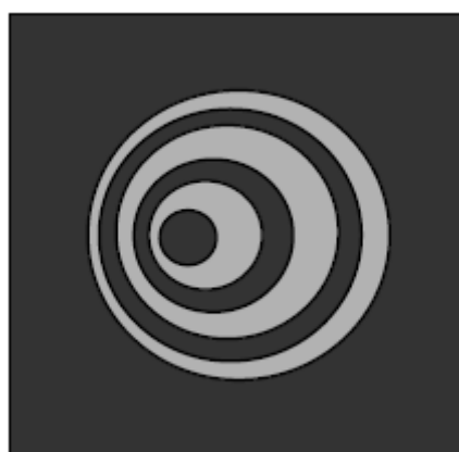
図4. 光軸のずれた星像
